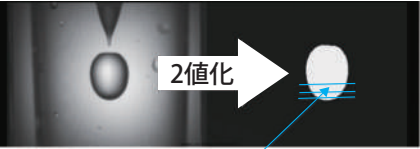
液滴撮影と2値化画像処理 (断面積を積分計算)
